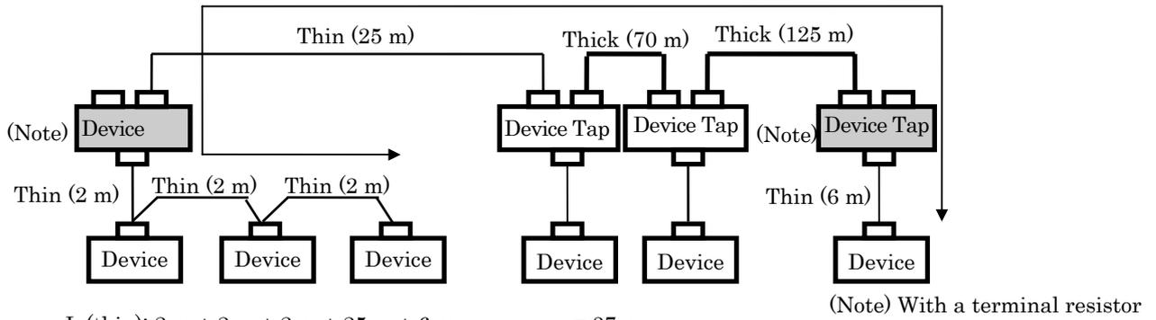
$$L (\text{thin}): 2 \text{ m} + 2 \text{ m} + 2 \text{ m} + 25 \text{ m} + 6 \text{ m} = 37 \text{ m}$$
